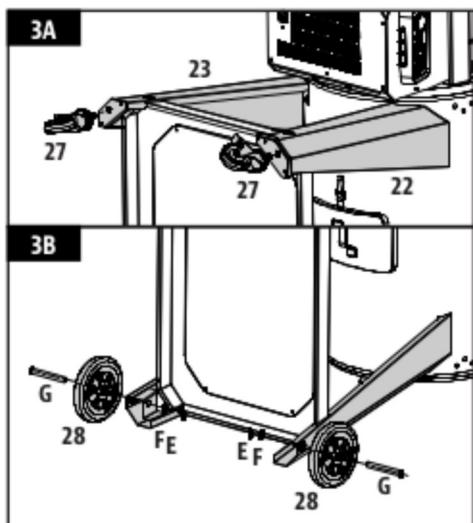
**DŮLEŽITÉ:** Znovu utáhněte šrouby podpěrných nohou, abyste se ujistili, že jsou po umísťení grilu do svislé polohy zcela zajistěné.
